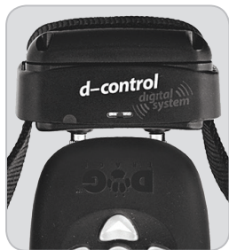
Postavení při zapínání/vypínání přijímače a při spárování vysílače s přijímačem
